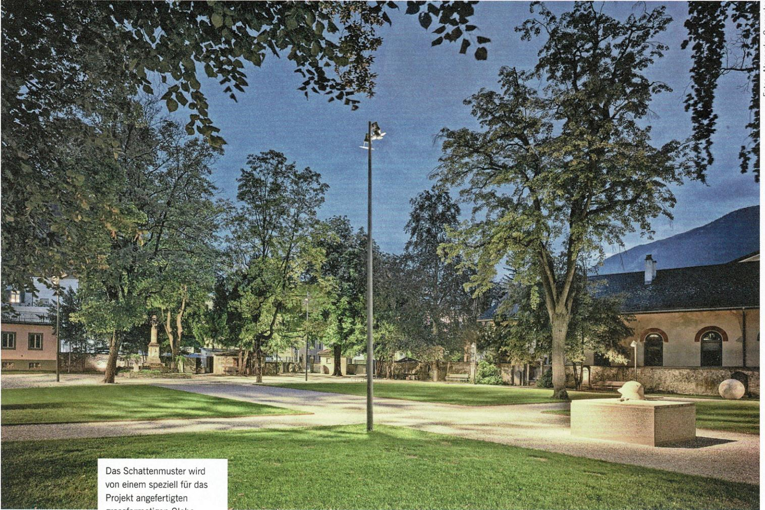
Das Schattenmuster wird von einem speziell für das Projekt angefertigten grossformatigen Globo erzeugt. Die Globos und IP-65-Scheinwerfer sind an sieben und acht Meter hohen Masten montiert.
