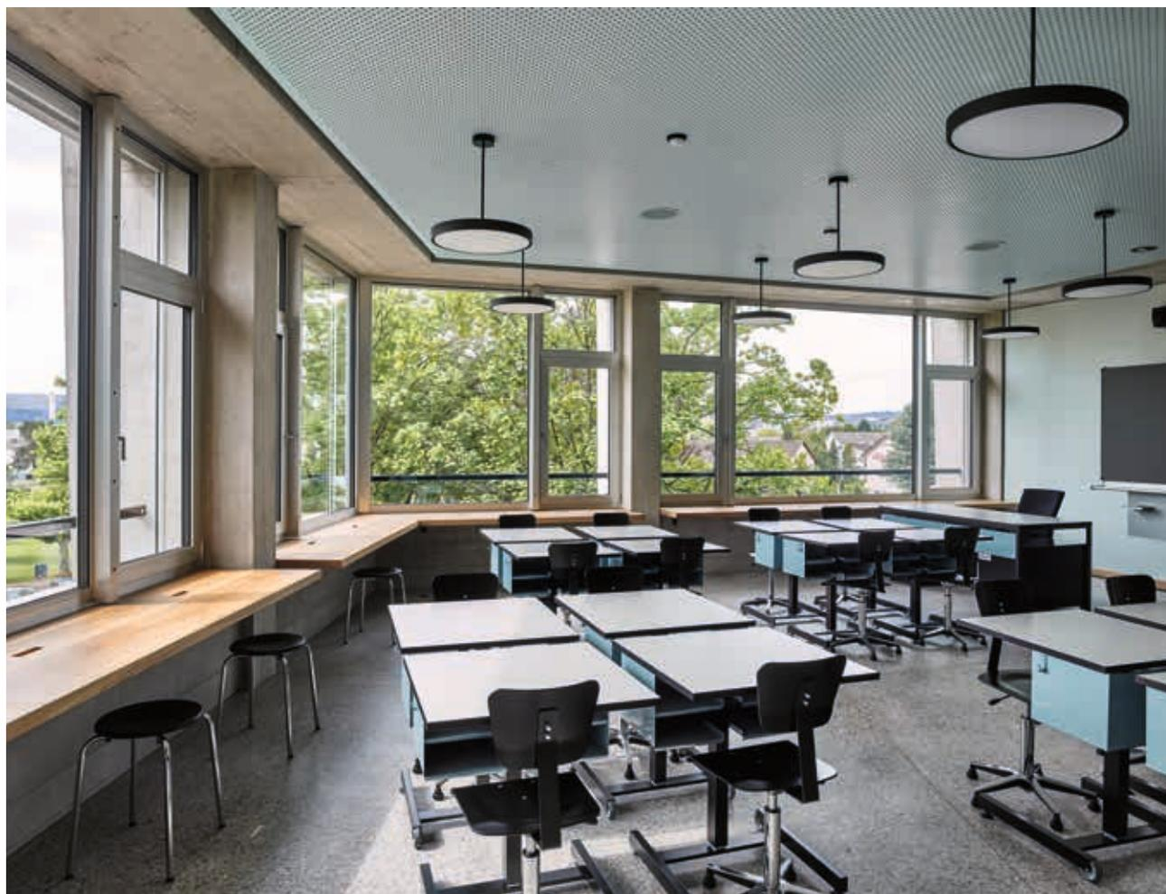
**Schulhaus Halden:** Durch die kompakte fünfeckige Grundform des Gebäudes gibt es fünf durchschnittlich belichtete Schulzimmer und fünf, die durch eine Übereckbelichtung sehr gute Tageslichtverhältnisse bieten. Die oftmals durch Blendung beeinträchtigten Sitzplätze an der Fassade werden hier nur temporär genutzt.
